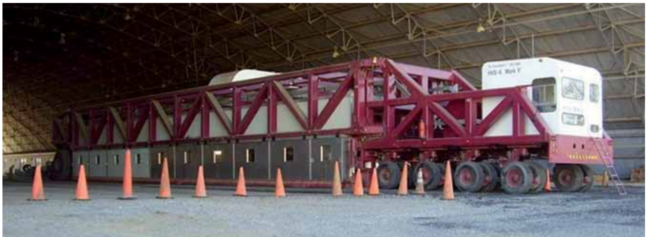
Ingenjers- och utvecklingscentret vid US Corps of Engineers utför accelererade tester i naturlig skala med överbyggnader på Tensar MSL.
